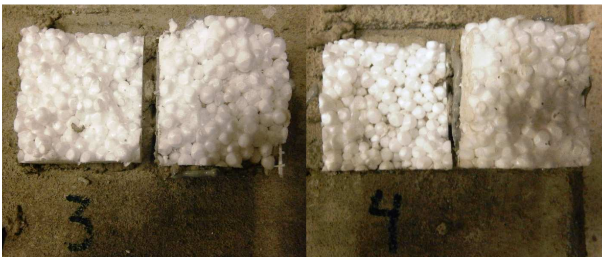
Figura A.3: Detalle del tipo de falla probetas N° 3 y 4
