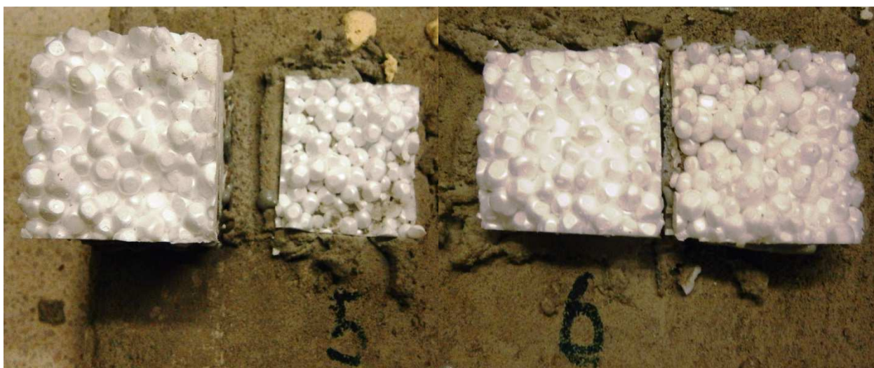
Figura B.4: Detalle del tipo de falla probetas N° 5 y 6
