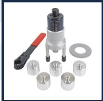
NCh 2471.Of2000: "Morteros – Ensayos de adherencia – Método de tracción directa".
