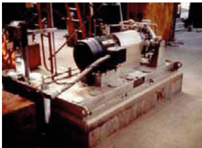
• Imagen 1. Grouting de base de motores
